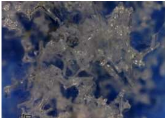
Obr. 4 Pohled na PUR zrna fr. 0/1 mm, u kterých je narušena buněčná struktura, zvětšeno 206 krát
