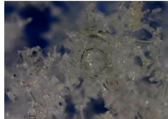
Obr. 5 Pohled na detail PUR zrna fr. 0/4 mm, zvětšeno 206 krát
